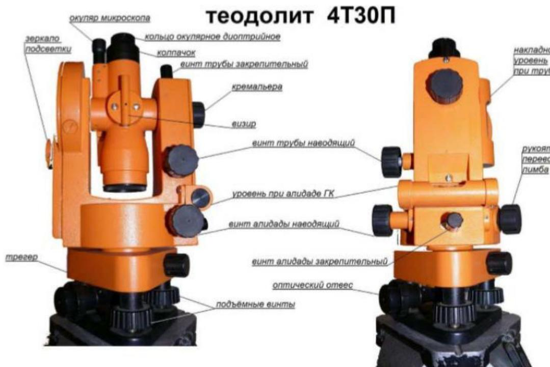
*Рисунок 1. Устройство теодолита*
