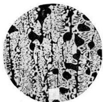
Рисунок 6 – Микроструктура *заэвтектического*
