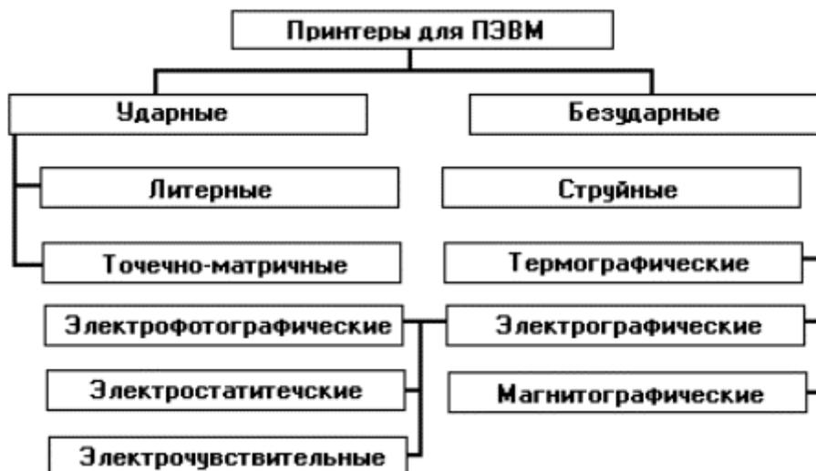
Принтеры ударного типа характеризуются тем, что изображение на бумагу наносится механическим способом. Из них в ПК применяются устройства с литерной печатью (литерные принтеры) и точечно-матричные принтеры.
