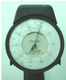
Рис. 4. Шкала прибора для измерения твердости.
