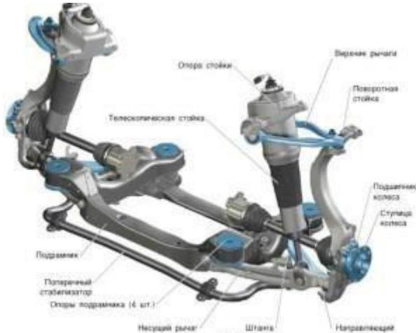
Основным несущим элементом подвески выступает подрамник, к нему фиксируются поперечные рычаги, соединенные с опорой ступицы, что в свою очередь обеспечивает ее поперечное положение. *Многорычажная задняя подвеска, которую устанавливают на современных автомобилях, состоит из трех или пяти поперечных рычагов.*
