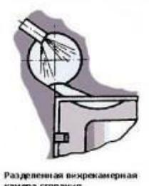
Разделенная вихревая камера сгорания
