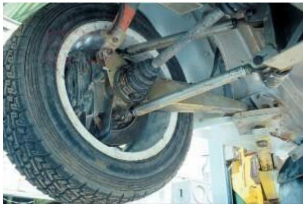
Продольный рычаг удерживает колеса в направлении продольной оси, крепление к кузову осуществляется при помощи опоры. Противоположный край рычага соединяется с опорой ступицы. На этом элементе располагаются подшипники и крепежи колес.
