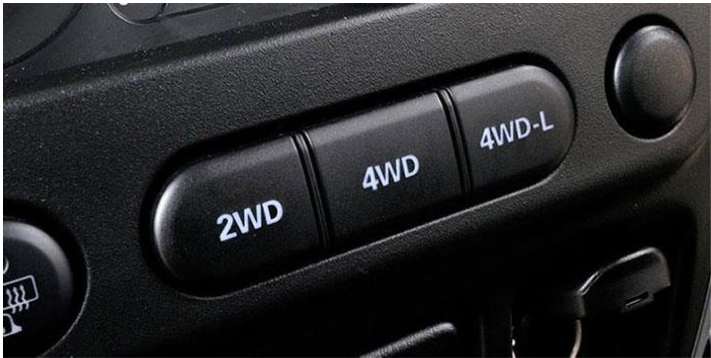
В такой трансмиссии отсутствует межосевой дифференциал, что обеспечивает постоянное соотношение распределение крутящего момента (обычно в пропорции 50/50).
