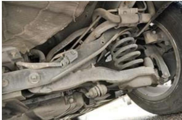
Многорычажная подвеска устанавливается на автомобили с задне- и переднеприводной компоновкой. Имеет более сложное устройство, поэтому используется на автомобилях дорогого класса. Впервые многорычажная подвеска была установлена на "Ягуар Е-Типе" в начале 60-х годов.
