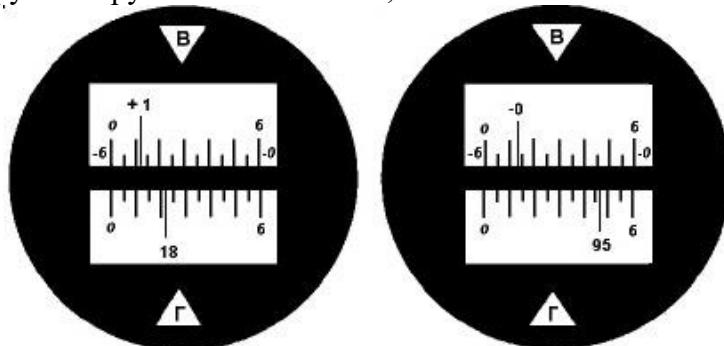
Рисунок 5. Поле зрения отсчетного микроскопа теодолита 4Т30П.
