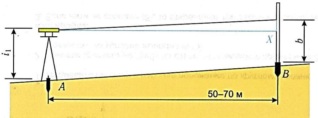
Рисунок 2. Схема выполнения поверки
