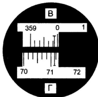
Рисунок 3. Поле зрения отсчетного микроскопа-оценщика теодолита ТЗО.
