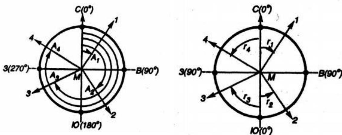
Рисунок 15. Азимуты и румбы направлений в разных четвертях
