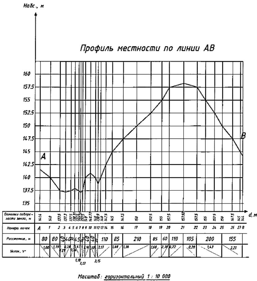
Рис. 2. Вертикальный профиль местности по линии АВ
