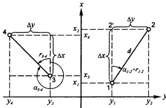
Проведя через точки 1-2 линии параллельные координатным осям, получим прямоугольный треугольник 1-2'-2, котором известна гипотенуза  $d_{1-2}$  и острый угол  $r = \alpha_{1-2}$ . Катеты этого треугольника есть приращения координат  $\Delta X$  и  $\Delta Y$ , которые могут быть получены по формулам:
