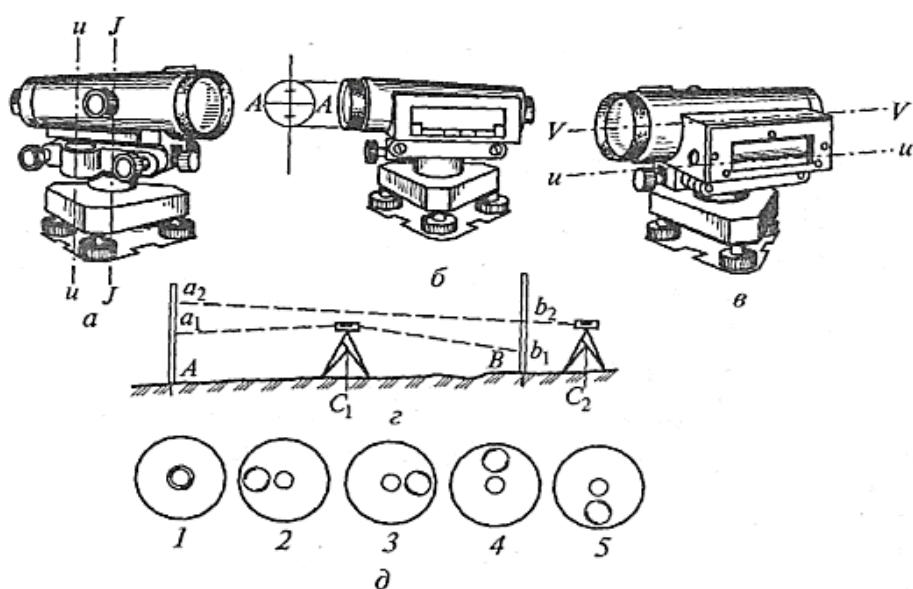
Рисунок 1. Поверки нивелира: а, б, в – схема расположения осей; г – положение нивелира при поверке главного условия; д – положения пузырька круглого уровня.
