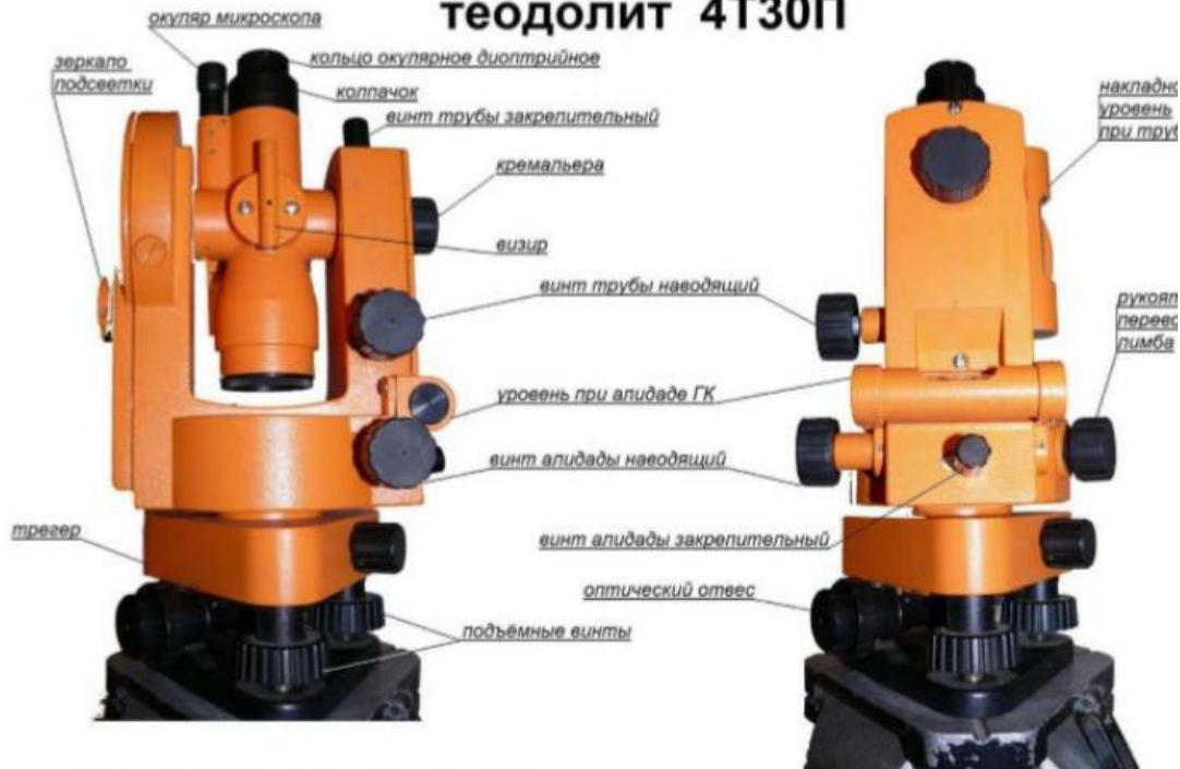
Рисунок 1. Устройство теодолита
