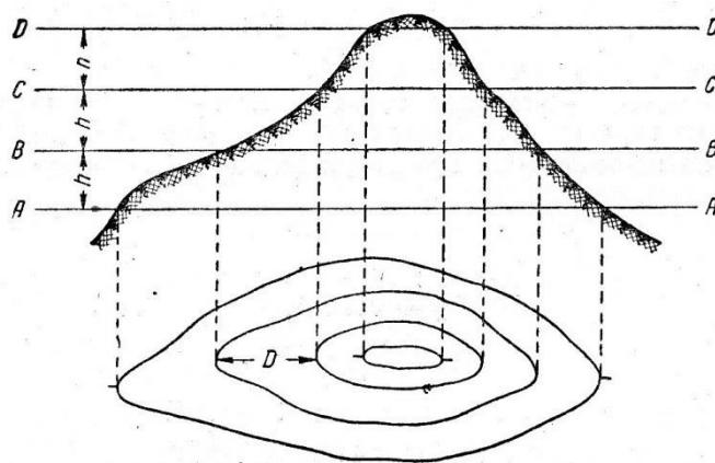
**Горизонталью** называется кривая линия, соединяющая точки с равными отметками на местности.
