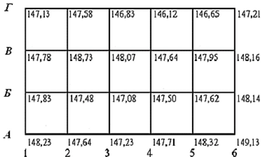
Рисунок 1. План площадки с отметками земли
