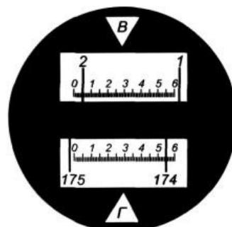
Рисунок 4. Поле зрения отсчетного микроскопа теодолита 2Т5К.
