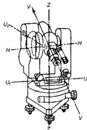
Рисунок 1. Основные оси теодолита:  $ZZ$  – осью вращения теодолита;  $VV$  – визирная ось  $HH$  – горизонтальная ось;  $U_1U_1$  – ось горизонтального цилиндрического уровня;  $U_2U_2$  – ось вертикального цилиндрического уровня
