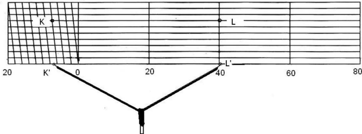
Рисунок 6. Определение длины линии с помощью поперечного масштаба 1:1000
