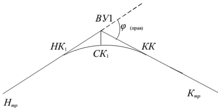
*Рисунок 3. Схема трассы*
