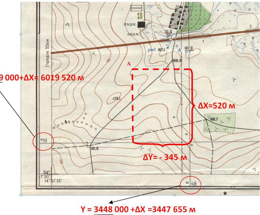
Рисунок 2. Определение прямоугольных координат
