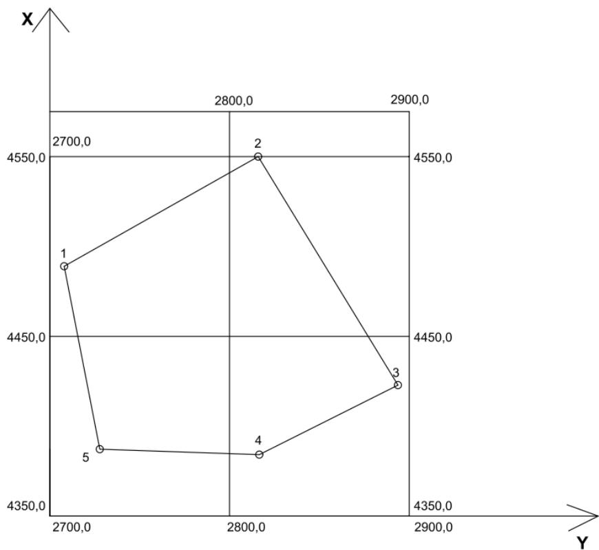
*Рисунок 3. Построение теодолитного хода по координатам*
