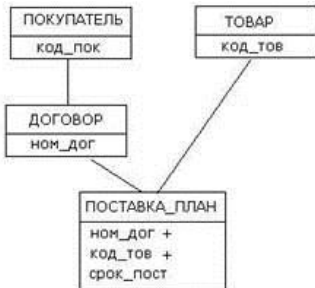
Рис.11.1. Фрагмент логической структуры реляционной базы данных предметной области "Поставка товаров"
