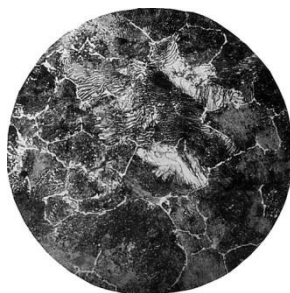
Микроструктура углеродистой стали ( \times 200 )
