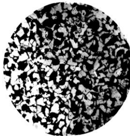
Микроструктура углеродистой стали (×250)
