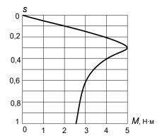
8-полюсный асинхронный двигатель, механическая характеристика которого изображена на рисунке, работает на частоте сети 50 Гц. Определить его максимальную механическую мощность.
