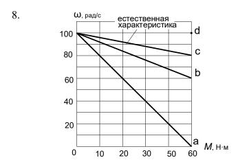
Сопротивление якоря двигателя постоянного тока, пусковые характеристики которого представлены на рисунке, равно 2 Ом. Определить сопротивление пускового реостата.
