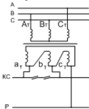
12. Определить потери мощности в проводах контактной сети ( $r_k = 0.07 \text{ Ом/км}$ ) для схемы:
