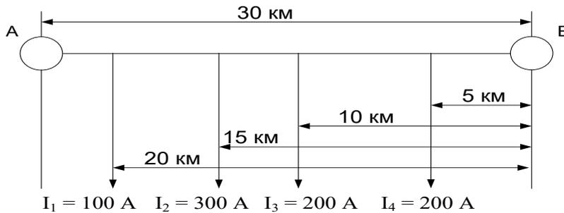
17. Рассчитать контур к.з. для схемы и ток к.з. (К-1) через выключатель Q:
