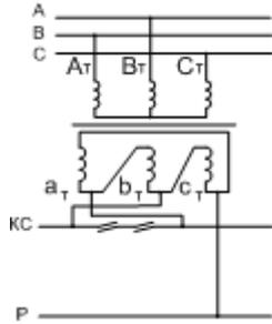
11 К каким фазам системы внешнего электроснабжения должны быть подключены обмотки, слева от изображенного на рисунке трансформатора, соединённого по схеме «звезда–треугольник», для обеспечения двустороннего питания межподстанционной зоны. Определите напряжение, приложенное в контактную сеть относительно системы внешнего электроснабжения.
