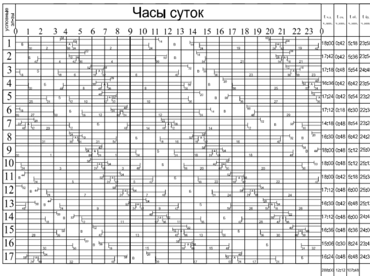
Рисунок 2.1 – График оборота локомотивов и локомотивных бригад на участке Б-А-В
