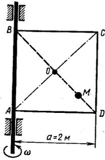
Квадрат ABCD вращается вокруг своей стороны AB с угловой скоростью  $\omega = 3t^2$ ,  $\omega$  - рад/с,  $t$  - в с. Точка M перемещается по диагонали BD согласно закону  $OM = S = \sqrt{2} \cos \pi t$ , где S - в м,  $t$  - с. Определить скорость точки M в момент времени  $t = 4$  с.
