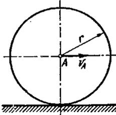
Колесо радиуса  $r = 0.7 \text{ м}$  катится без скольжения по горизонтальному пути. Определить кинетическую энергию колеса если его центр движения с постоянной скоростью  $V_A = 4 \text{ м/с}$ .
