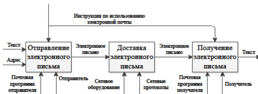
Рисунок 1 – Модель информационной системы «Электронная почта»
