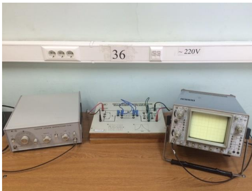
Лабораторная установка «Вынужденные электрические колебания. Резонанс»
