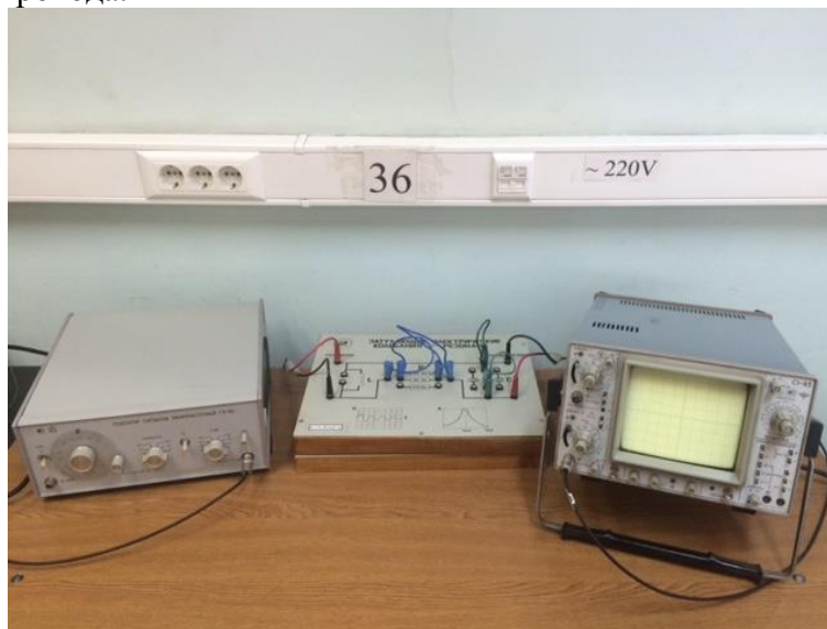
Лабораторная установка «Вынужденные электрические колебания. Резонанс»
