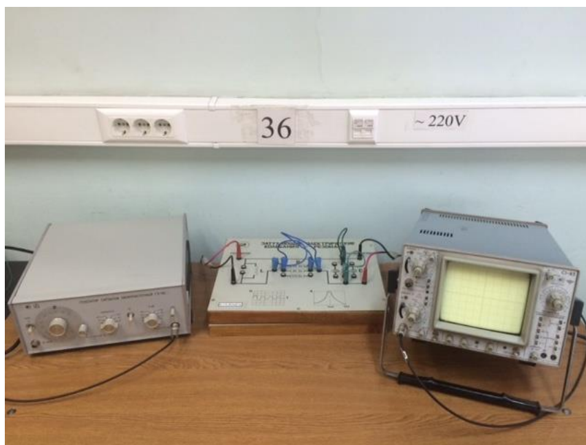
Лабораторная установка «Вынужденные электрические колебания. Резонанс»
