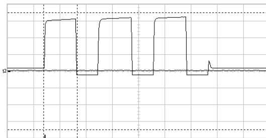
Рисунок 5 – Осциллограмма импульсного набора номера абонента
