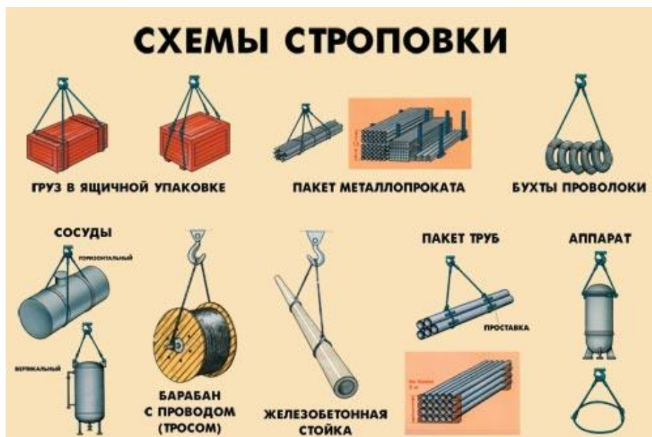
Рисунок 2. Схемы строповки
