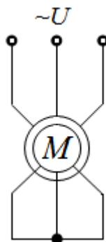
Рисунок 19 – Схема для получения естественной характеристики
