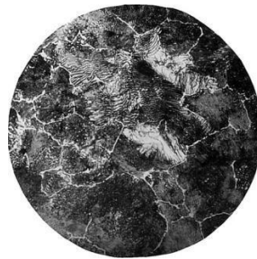
Микроструктура углеродистой стали ( \times 200 )
