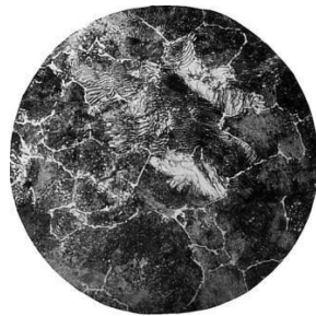
Микроструктура углеродистой стали ( \times 200 )
