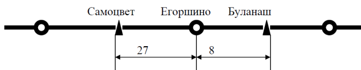
Рисунок 4 Расчет тарифного расстояния, при условии, что станции отправления и назначения расположены на двух смежных (соседних) участках
