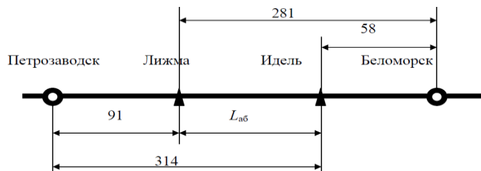
Рисунок 2 Расчет тарифного расстояния, при условии, что железнодорожные станции отправления и назначения расположены в пределах одного участка
