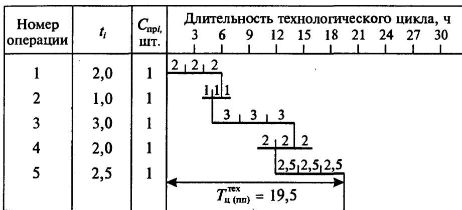
Рис. 1.2. График длительности технологического цикла при параллельно-последовательном виде движений партии деталей в производстве
