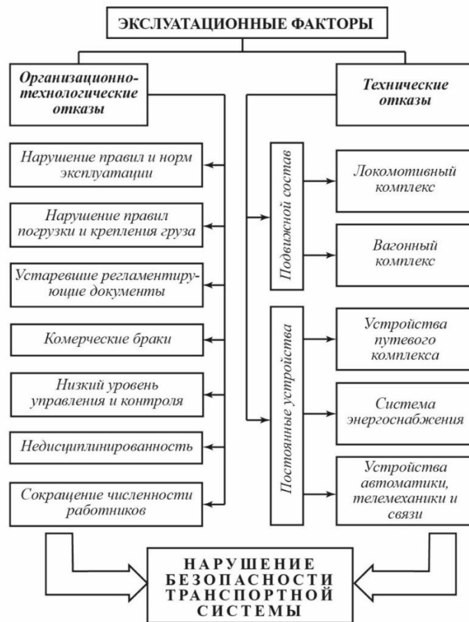
Рисунок 1.3. Эксплуатационные факторы, воздействующие на состояние безопасности ЖДТС
