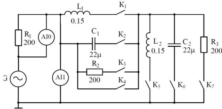
Рис. 1.2. Электрическая схема лабораторной работы
