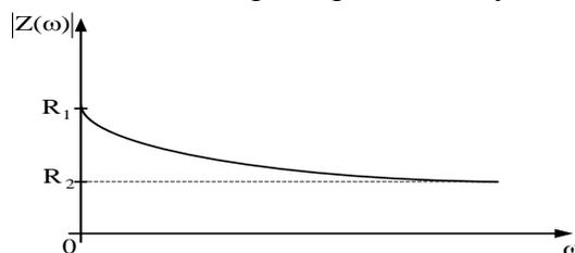
Задание: составить схему пассивного двухполюсника, модуль сопротивления которого изменяется с ростом частоты по заданной кривой.
