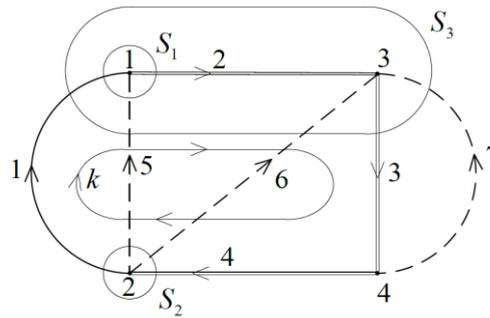
Рис. 2.2 – Главные сечения и независимый контур графа.
