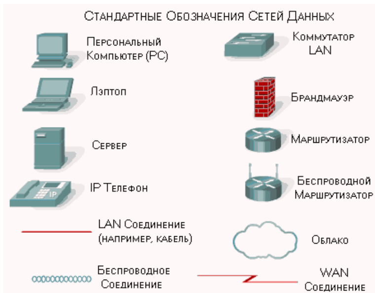
Рис. 1. Условные обозначения элементов компьютерной сети – исследование корпоративного сектора рынка программно - технических средств для комплектации серверных конфигураций ИС компании.
