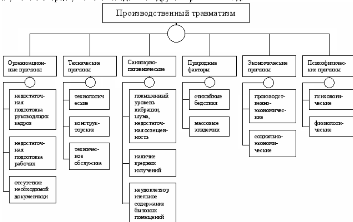
Рис. 1.1. Пример дерева причин несчастных случаев на производстве
