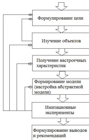
Рис. 1 Схема использования системы ИСТРА для моделирования транспортных систем
