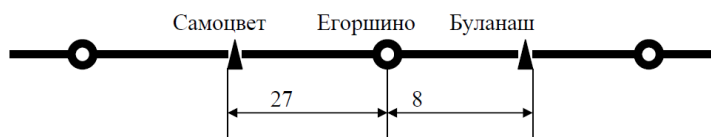
Рисунок 4 Расчета тарифного расстояния, при условии, что станции отправления и назначения расположены на двух смежных (соседних) участках
