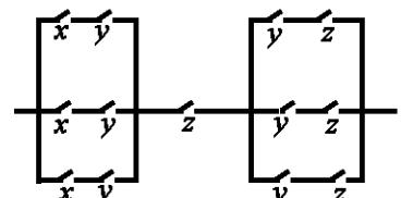
23. Имеется длинный коридор, вдоль стен которого размещены лампы. Включение и выключение системы освещения контролируется двумя выключателями на входе и выходе. Требуется создать такую систему переключателей, которая позволяет на каждом конце коридора изменять состояние системы на противоположное.
