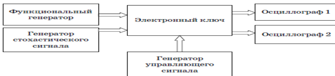
Рис. 6.4. Структурная схема исследования процесса дискретизации и квантования сигналов
