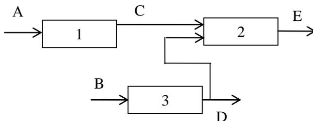
ми обозначены номера блоков системы, а буквенное обозначение имеют ее входы и выходы. Будем обозначать единицей (1) состояние блока, если оно удовлетворяет требованиям работоспособности, а нулем (0) – если не удовлетворяет. Необходимо отметить, что если на вход работоспособного блока подать сигнал, не соответствующий техническим требованиям и ограничениям, то работоспособный блок отреагирует на такой входной сигнал, как блок отказавший.
