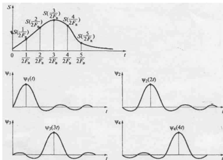
Рис. 6.2. Формирование отсчётов аналогового сигнала в дискретные моменты времени
