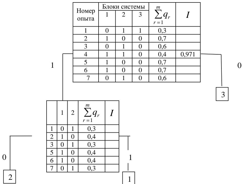
В качестве следующей проверки, в силу множественности суммарных отказов, проверка  $\pi_2$ , которая показывает, что полученная суммарная условная информация с превышением покрывает энтропию системы. Таким образом мы нашли последовательность проверок  $\{\pi_4, \pi_2\}$ . Последовательность наших проверок образует следующий граф, изображенный на рисунке.
