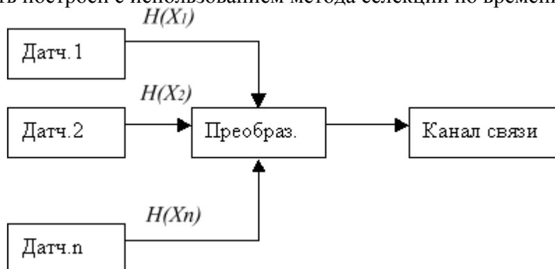
Рис.3.6. Комплексный датчик
