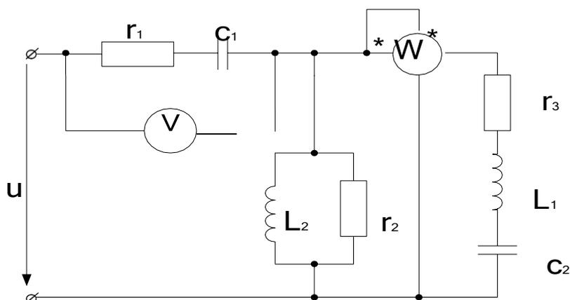
Рис. 1.1. Электрические цепи однофазного синусоидального тока
