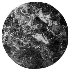
Микроструктура углеродистой стали (×200)
