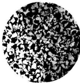
Микроструктура углеродистой стали ( \times 250 )
