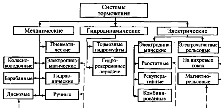
Рис. 2. Классификация систем торможения подвижного состава
