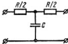
3. Определить частоту среза ФВЧ, если  $R = 510 \text{ Ом}$ ,  $C = 3,3 \text{ нФ}$ .
