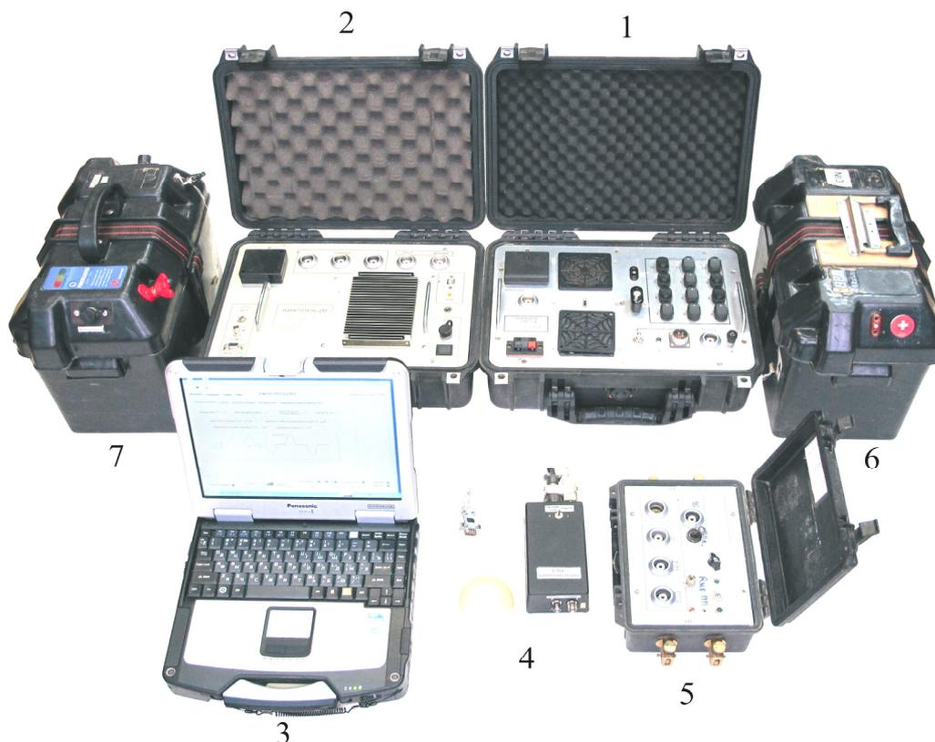
**Рис. 13. Экспериментальный образец программно-аппаратного комплекса *STEM-1*.**
