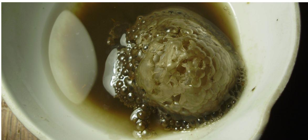
Рис. 4. Образец разделения углеводородов по фракциям после растворения в соляной кислоте карбонатной составляющей стяжений
