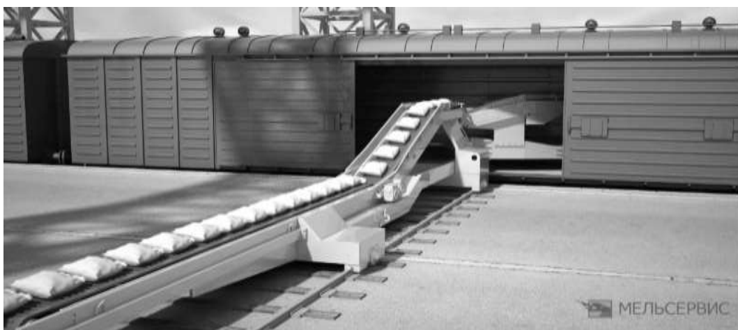
Рисунок 2 – Размещения груза в вагон мешкопогрузчиком КМПВ
