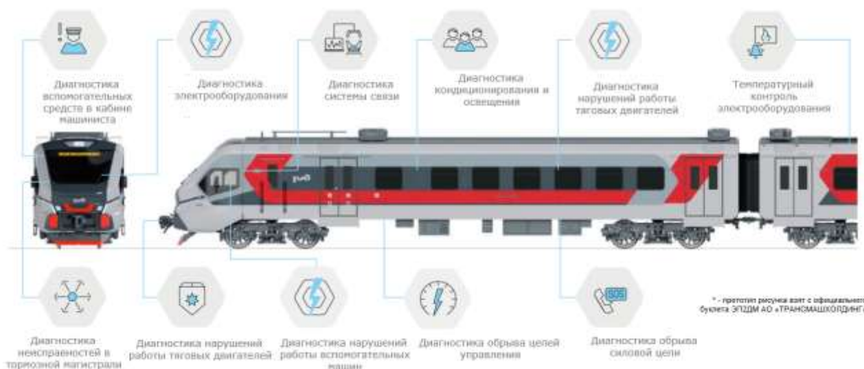
Рисунок 1 – Перечень контролируемых параметров современными системами мониторинга технического состояния
