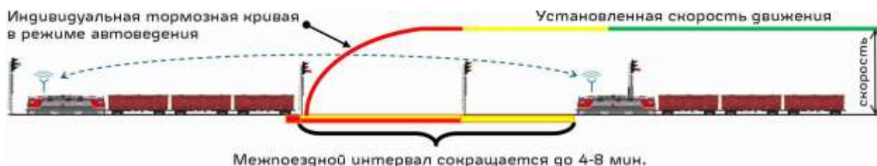
Рисунок 1 – Схема движения поездов по технологии ВСЦ
