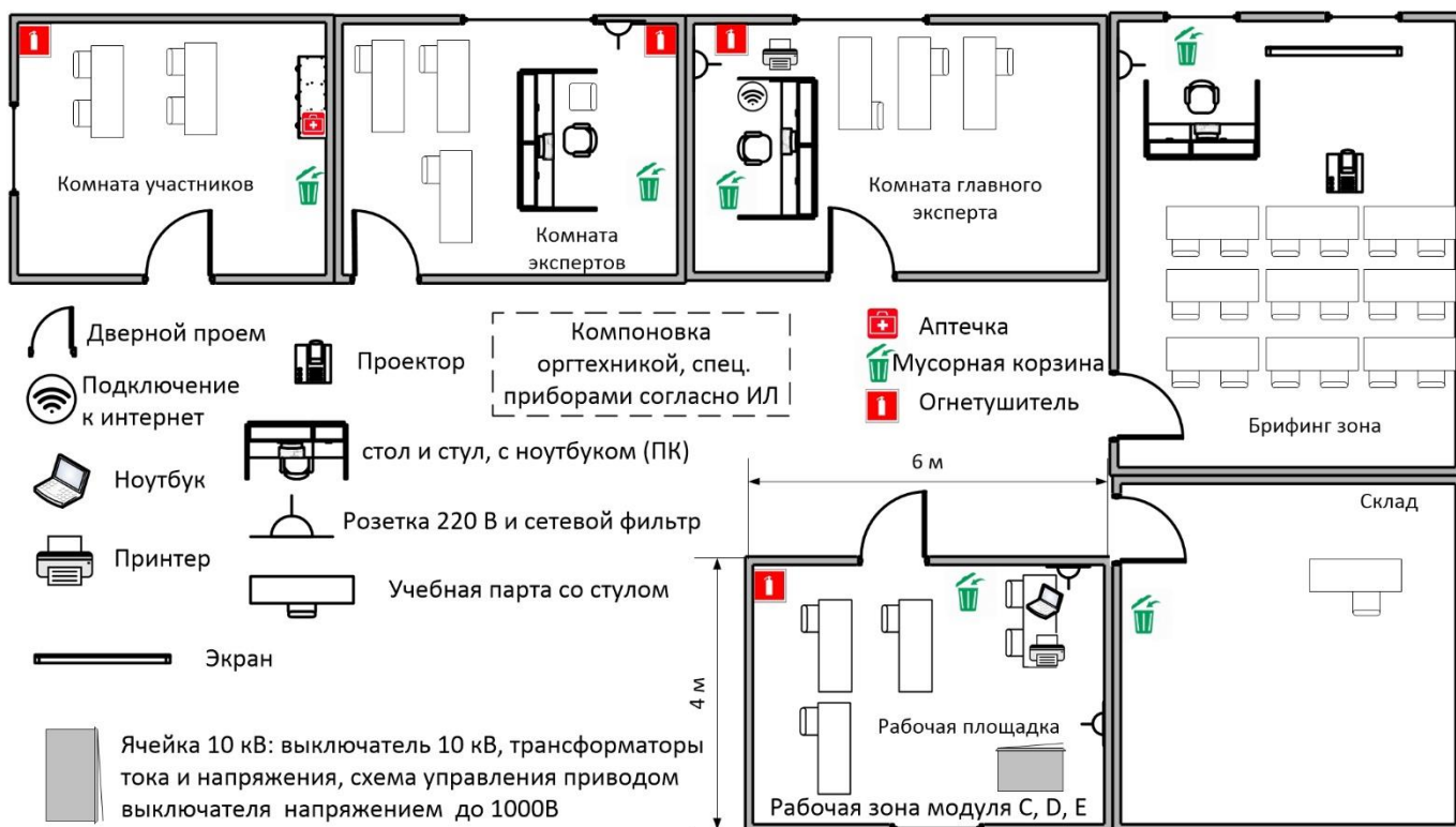
Рисунок IV.1 - План застройки площадки центра проведения демонстрационного экзамена
