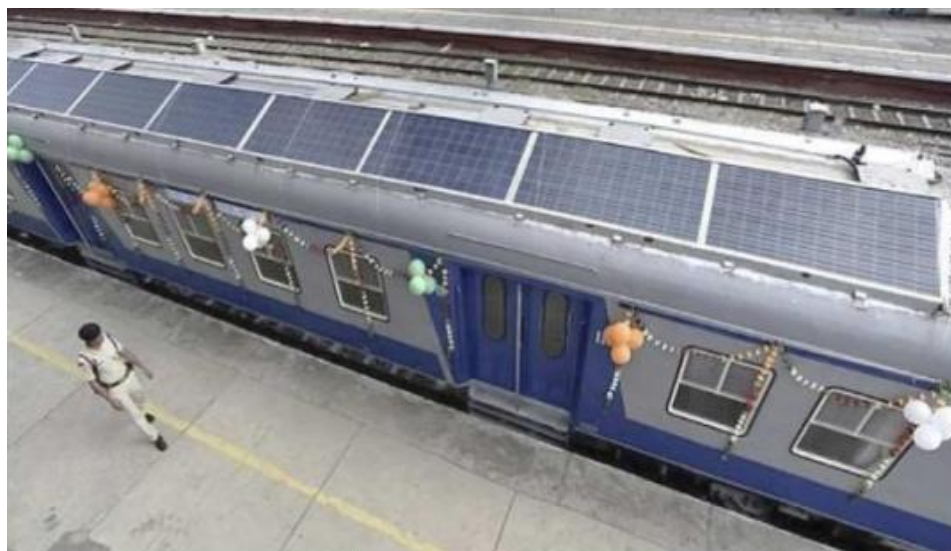
Рисунок 2 – Гибридный поезд на солнечных батареях
