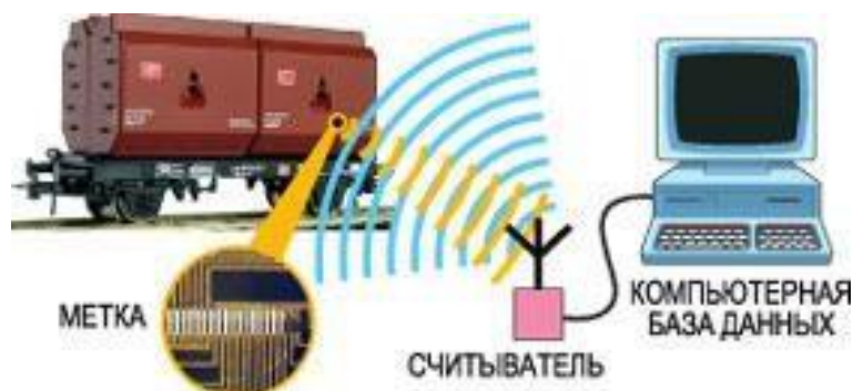
Рисунок – 1 Составляющие RFID
