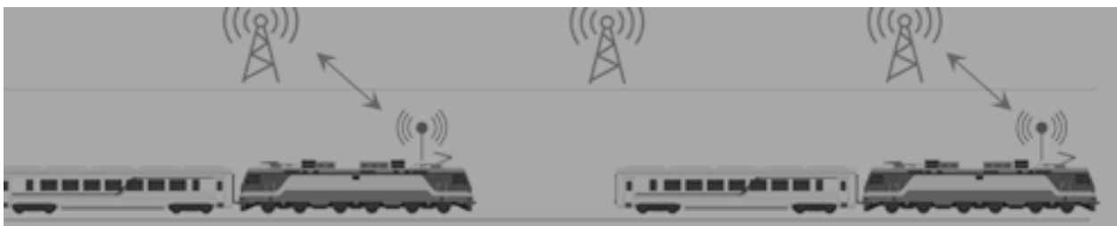
Рисунок 4 – Виртуальная сцепка с обменом данными через радиоблок-центр
