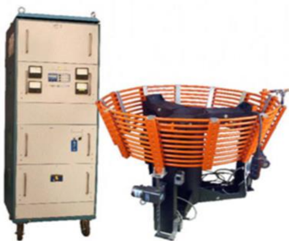
Рисунок 1 – Инновационный стенд по смене бандажа колесных пар тягового подвижного состава
