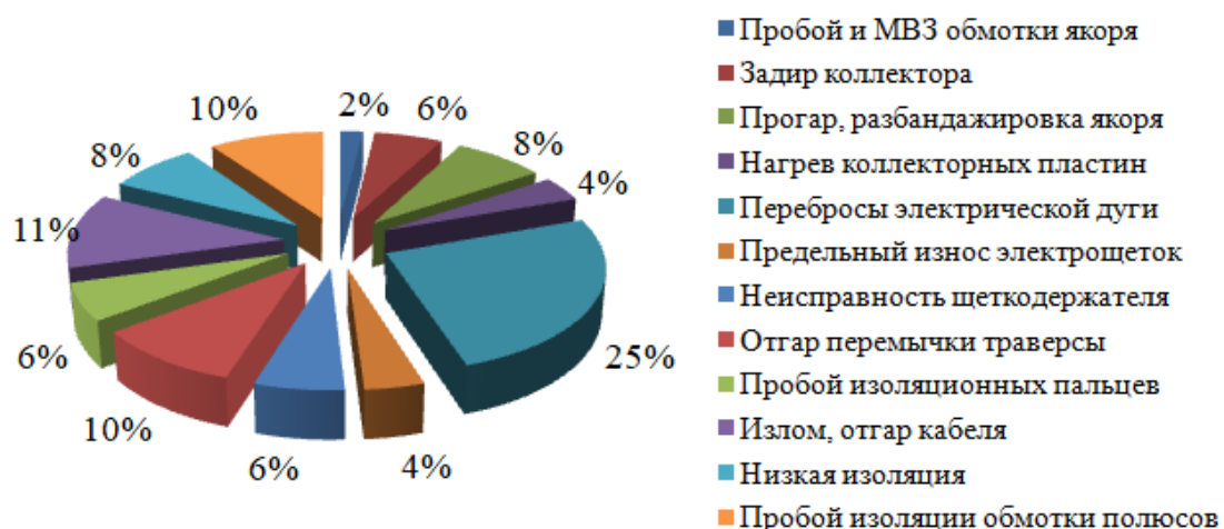
Рисунок 2 – Распределение отказов тяговых двигателей электровозов по элементам конструкции
