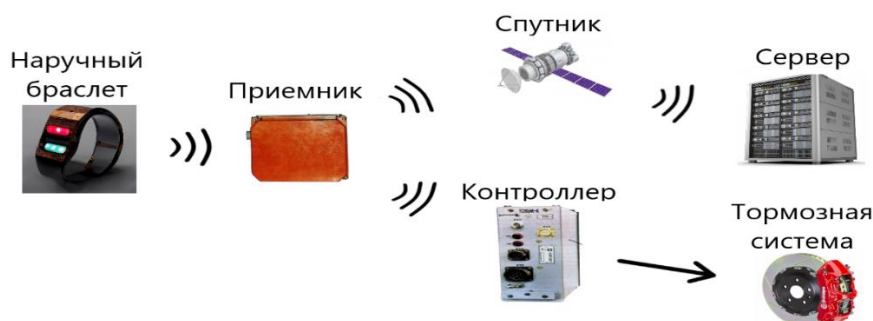
Рисунок 2 – Принцип работы предлагаемой системы контроля бдительности водителя
