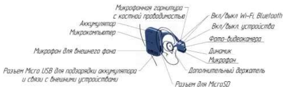
Рисунок 2 – Голосовое информационное устройство осмотрщика вагонов
