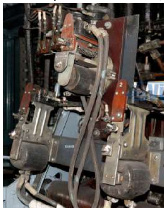
Рисунок 4 – Реле боксования (элемент электронной диагностики)
