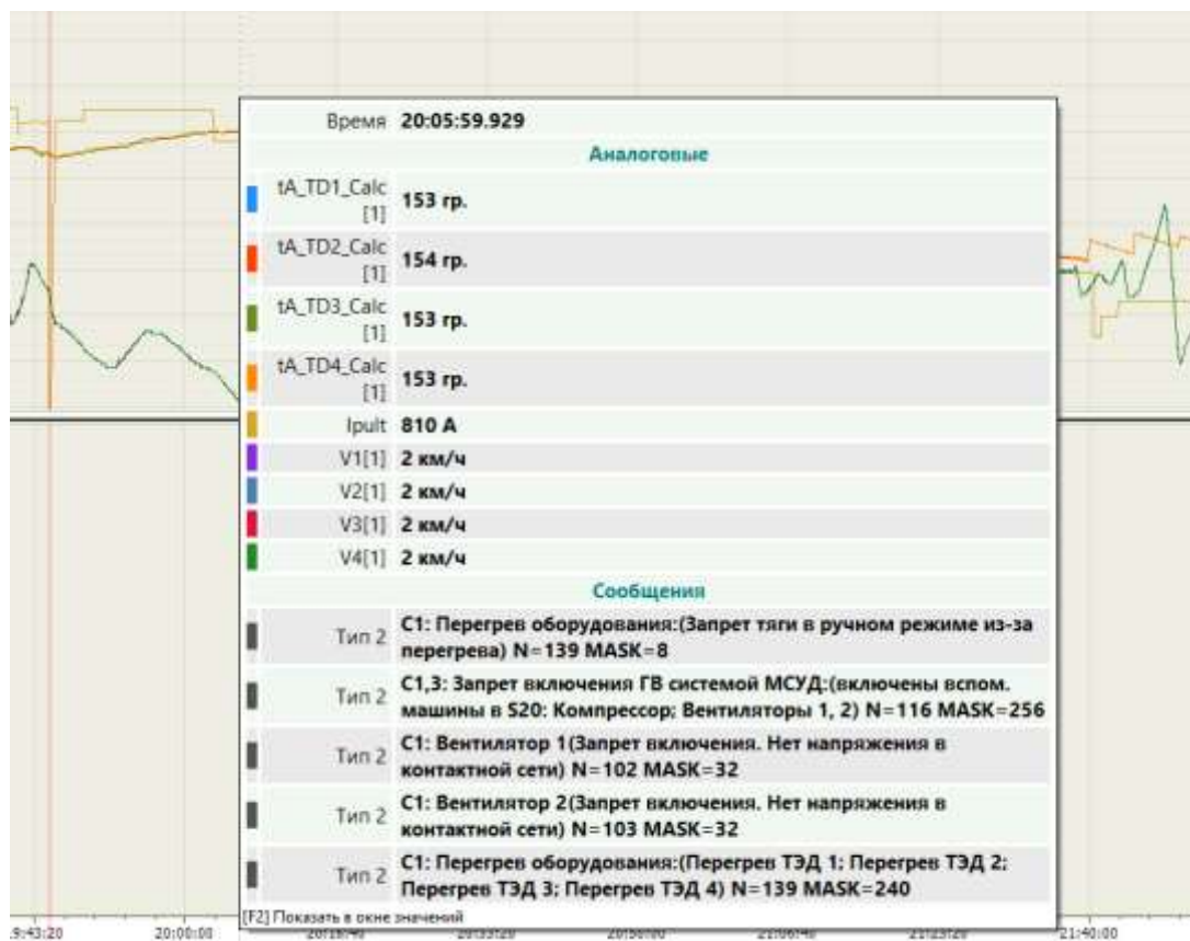
Рисунок 3 – Перегрев ТЭД при движении поезда 3ЭС5К с весом поезда 7050 тонн
