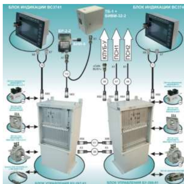
Рисунок 7 – Система управления на базе МСУД электровозов серий ЭС5К (НЭВ3)
