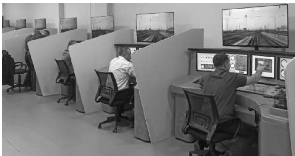
Рисунок 4 – Итоговая аттестация на тренажерном комплексе тягового подвижного состава с программным обеспечением «виртуальный-ведущий» и «виртуальный-ведомый» по технологии «виртуальная сцепка»
