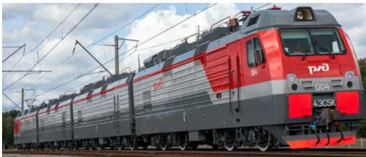
Рисунок 1 – Самый мощный отечественный электровоз серии 4ЭС5К (до 14 МВт)
