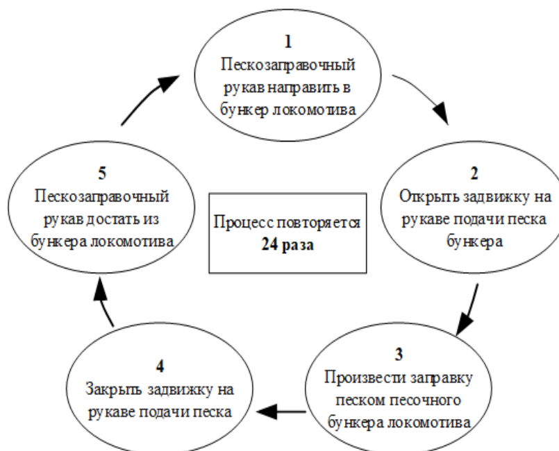
Рисунок 3 – Технологический процесс заправки электровоза серии 3ЭС5К песком при работе штатной системы пескоподачи
