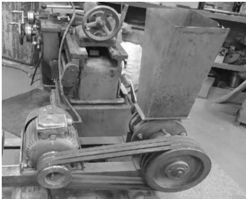
Рисунок 1 - Общий вид лабораторной установки для размала вермикулита МРС-6
