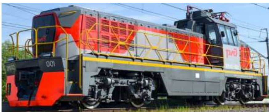
Рисунок 3 – Контактнo-аккумуляторный маневровый электровоз серии ЭМКА2
