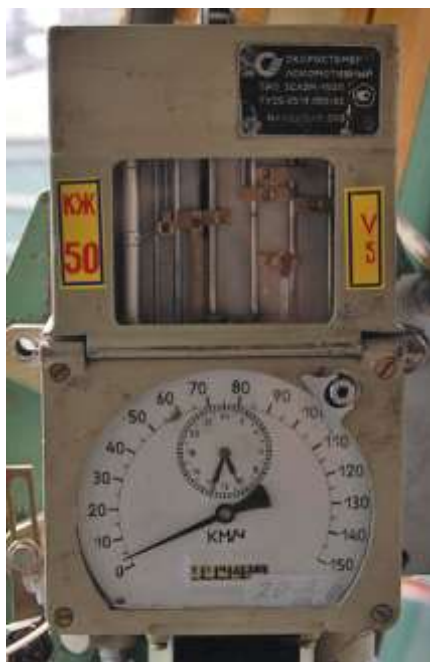
Рисунок 2 – Скоростемер ЗСЛ-2М (механическая и пневматическая диагностика)
