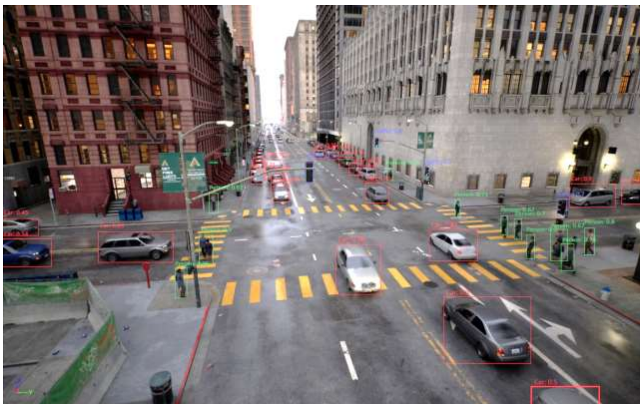
Рисунок 5 – Распознавание объектов интереса и принятие решений переключения светофоров для регуляции транспортных и пешеходных потоков
