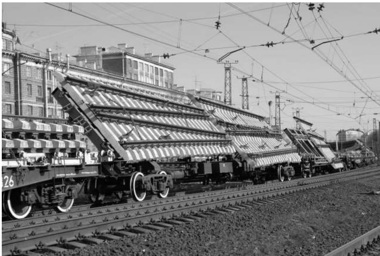
Рисунок 1 – Специальные платформы для блоков стрелочного перевода ППВ-2К
