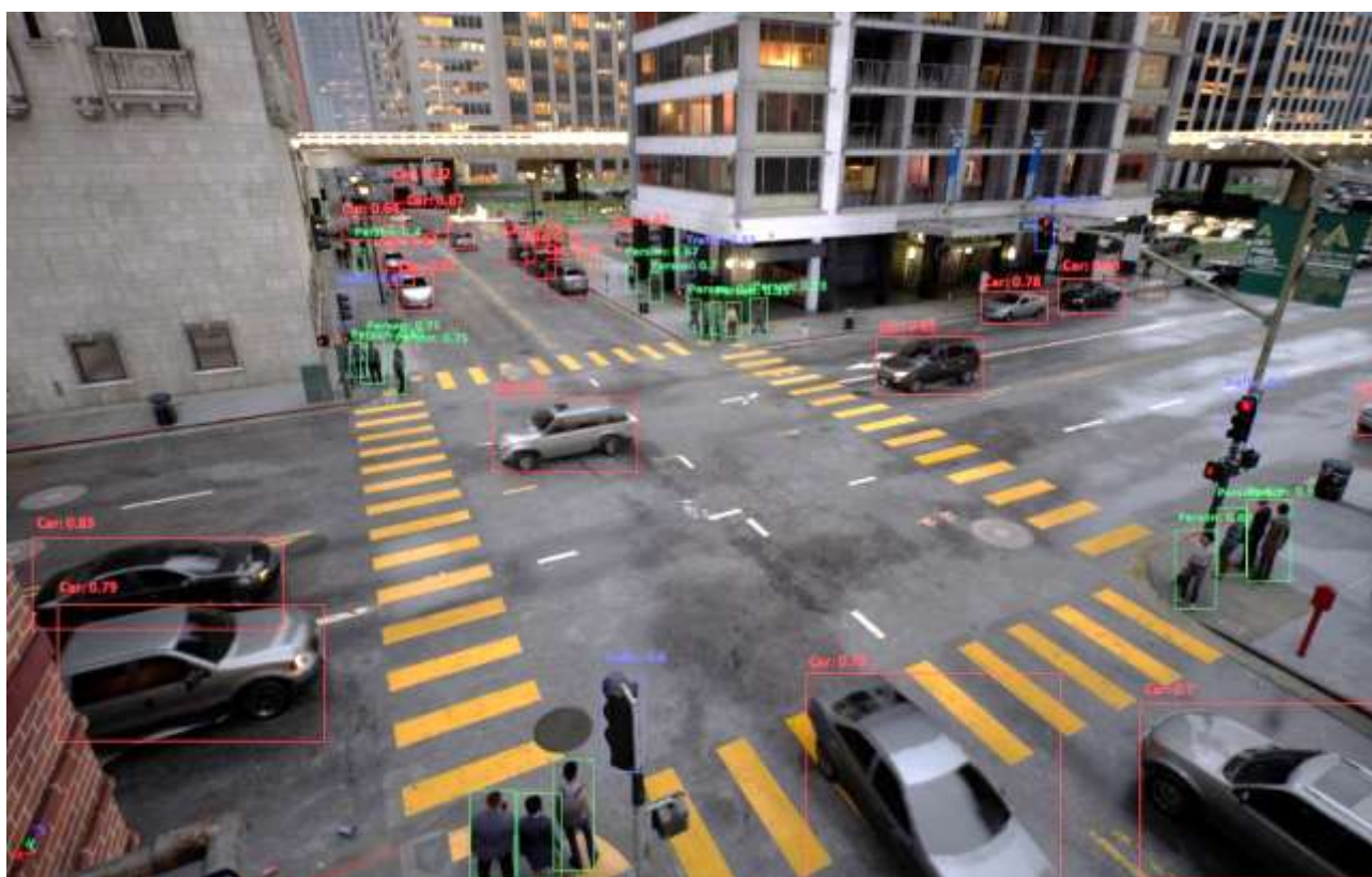
Рисунок 6 – Распознавание объектов интереса и принятие решений переключения светофоров для регуляции транспортных и пешеходных потоков
