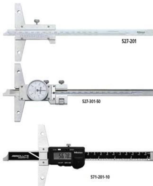
Рисунок 7 – Пример Штангенглубиномеров
