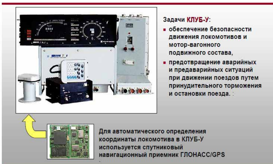
Рис. 2. Навигационный приёмник МНП-МЗ/К в составе КЛУБ-У
