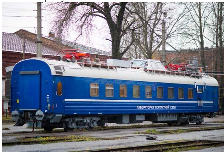
Рис. 1. Вагон испытания контактной сети
