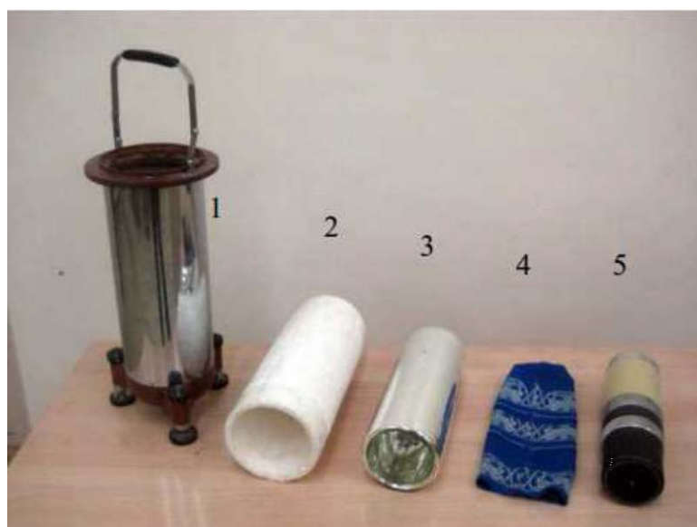
Рис.3. Составные части гравиметра
