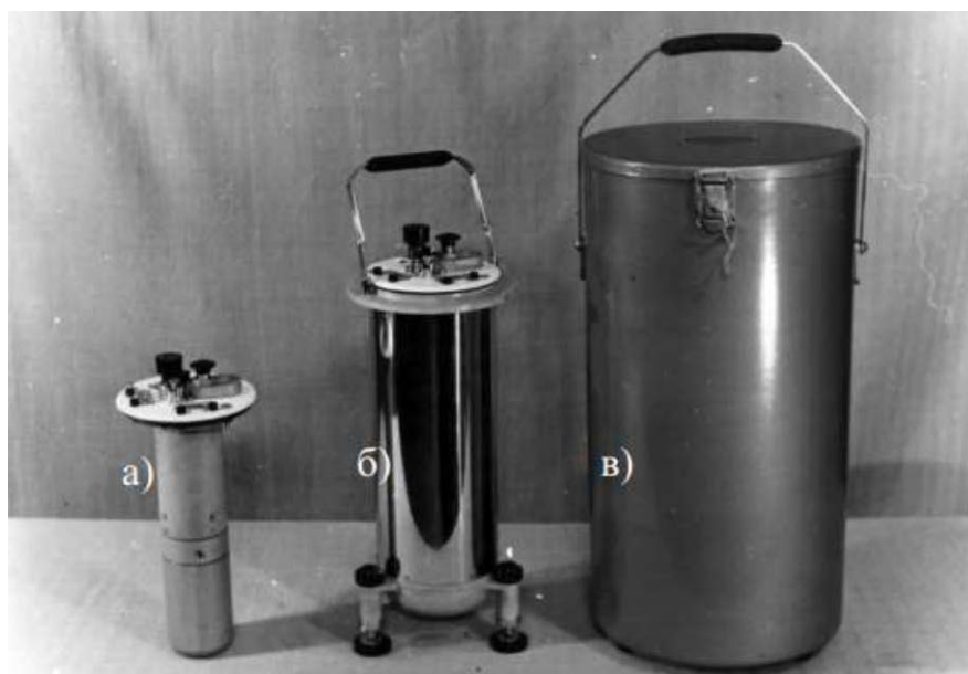
Рис. 2. Гравиметр: а) внутренняя часть прибора; б) общий вид прибора; в) транспортировочный футляр цилиндрической формы, изготовленный из жести
