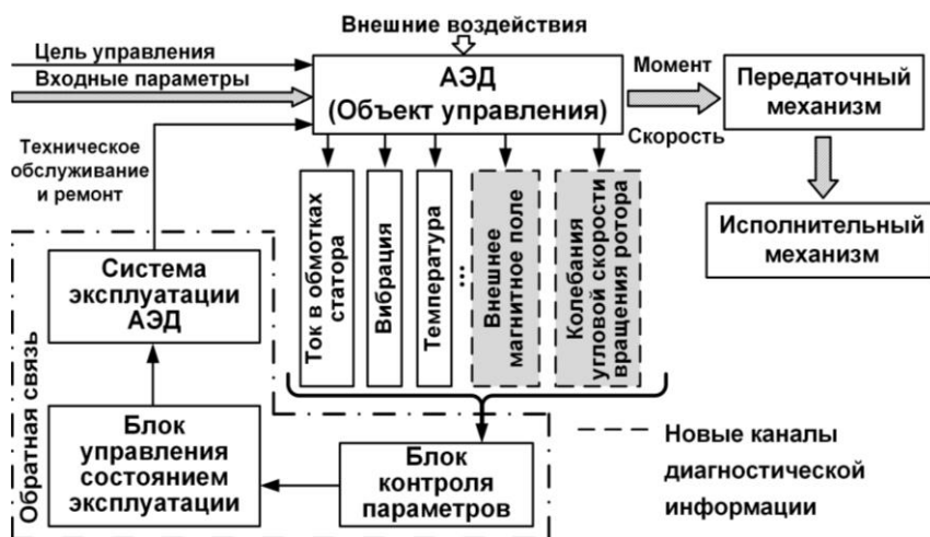
Рисунок 1 – Обобщённая схема управления техническим состоянием АЭД в составе сложной системы
