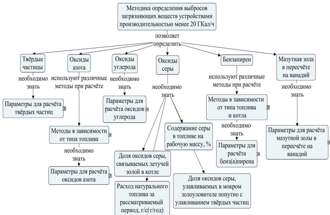
Рисунок 2.14. Онтология методики определения выбросов загрязняющих веществ устройствами производительностью менее 20 ГКал/ч
