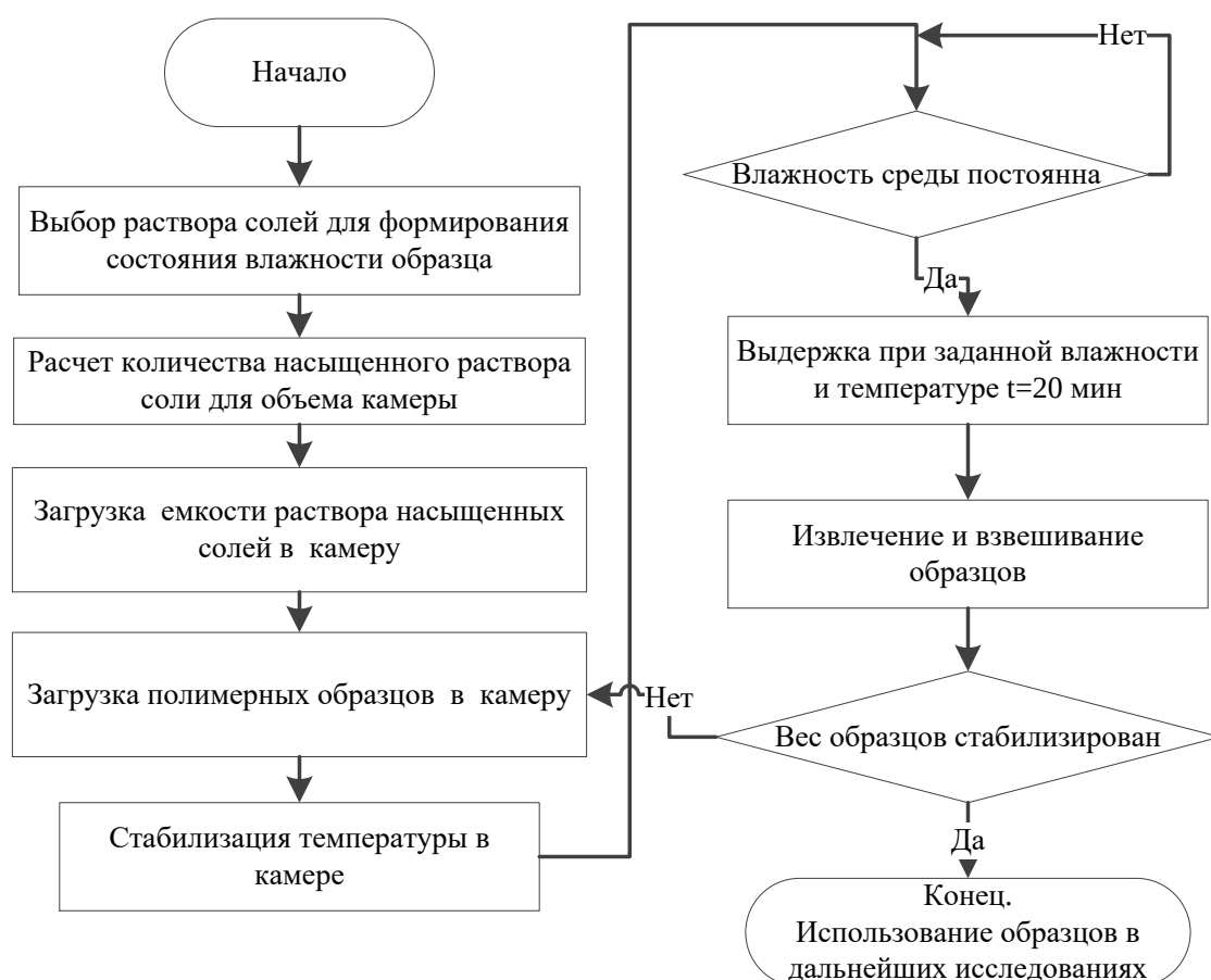
Рисунок 31 – Блок-схема последовательности выполнения работ для формирования состояния влажности образцов полимерных материалов
