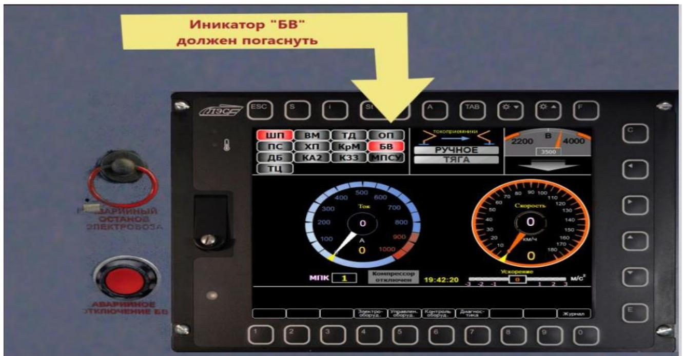
Рисунок 14 – Порядок действий после замыкания контактов БВ
