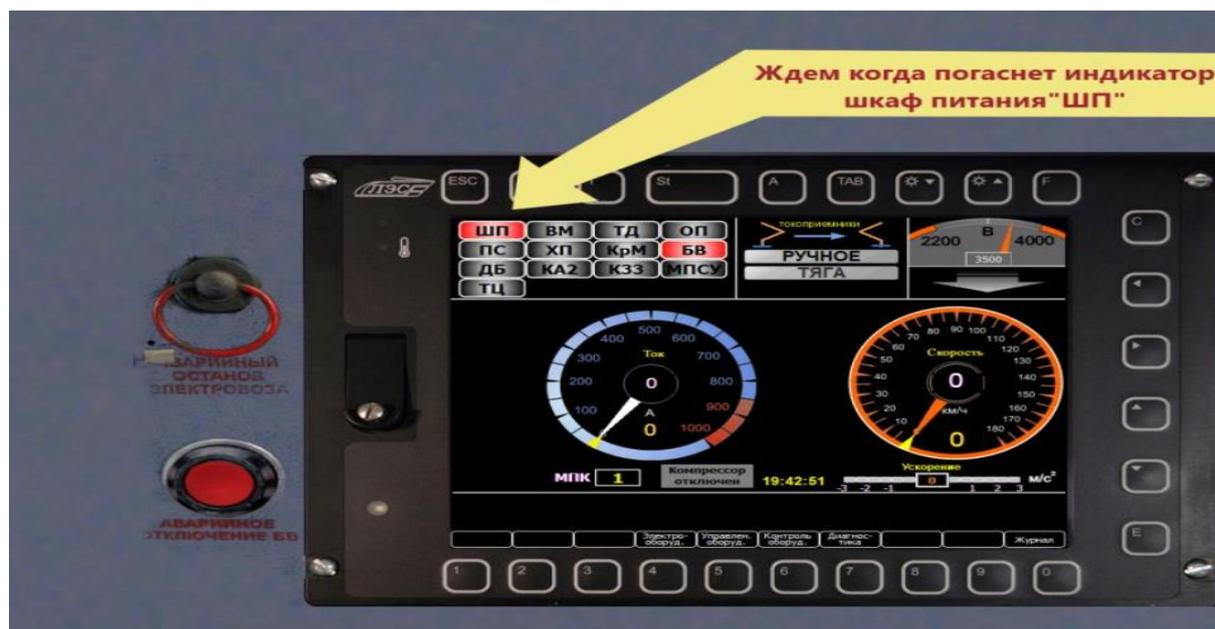
Рисунок 16 – Порядок действий после включения тумблера «Преобразователи»
