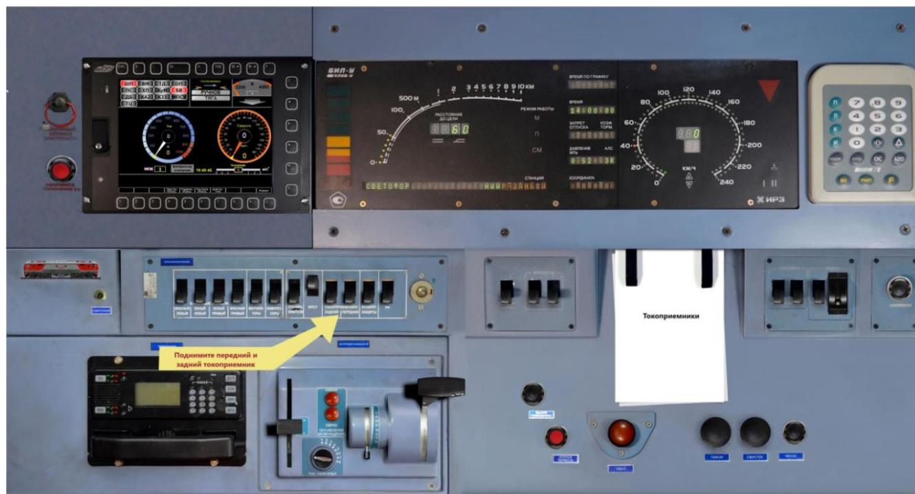
Рисунок 10 – Порядок действий при поднятии токоприемников
