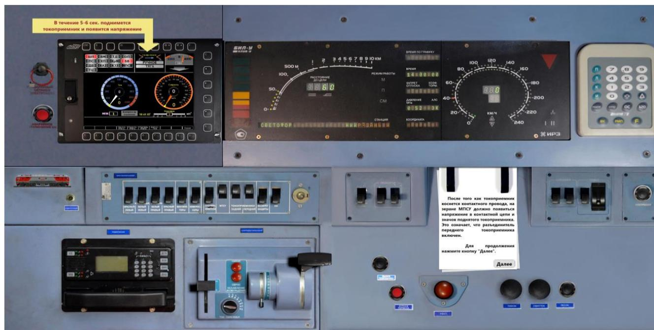
Рисунок 11 – Порядок действий при ожидании поднятия токоприёмников
