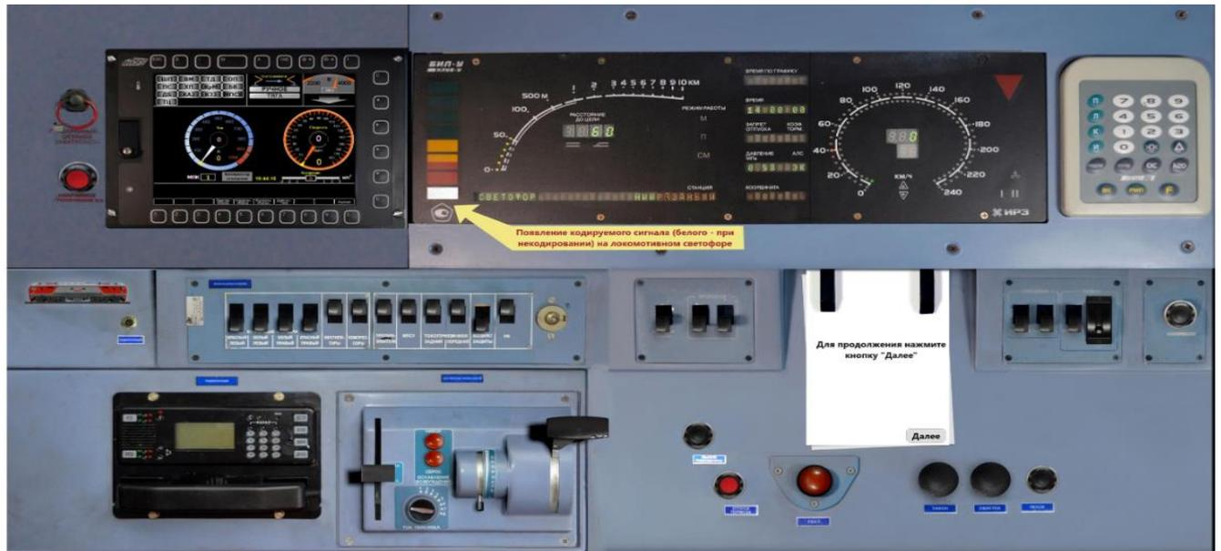
Рисунок 19 – Порядок действий после включения тумблера «Вентиляторы»
