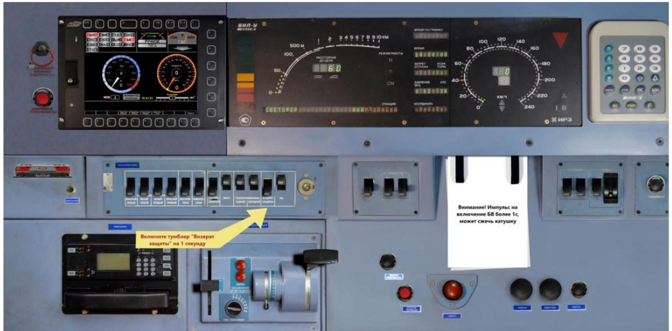
Рисунок 13 – Порядок действий при включении тумблера «Возврат защиты»
