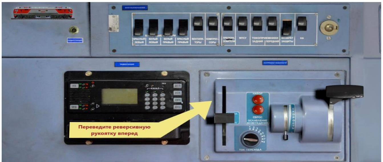
Рисунок 20 – Порядок действий после кодирования сигнала на локомотивном светофоре
