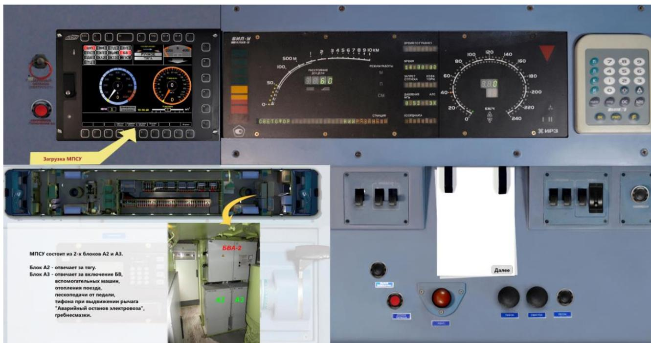
Рисунок 9 – Порядок действий при загрузке «МПСУ»
