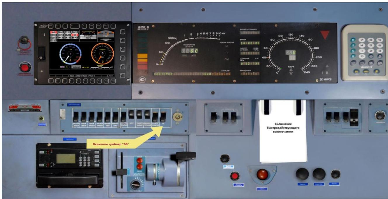
Рисунок 12 – Порядок действий при включении тумблера «БВ»
