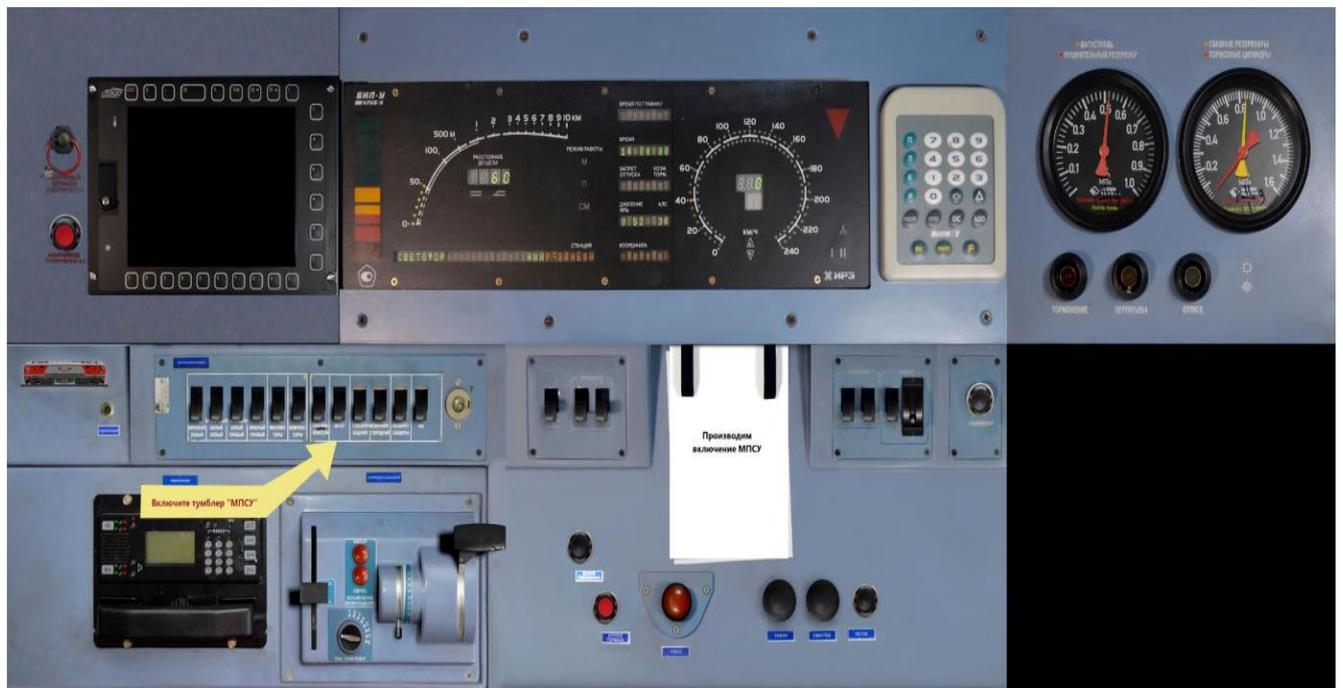
Рисунок 8 – Порядок действий на пульте управления при включении «МПСУ»
