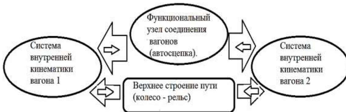
Рис. 4. Схема системы внешних силовых и вибрационных воздействий на узлы и детали грузового вагона, движущегося в составе поезда
