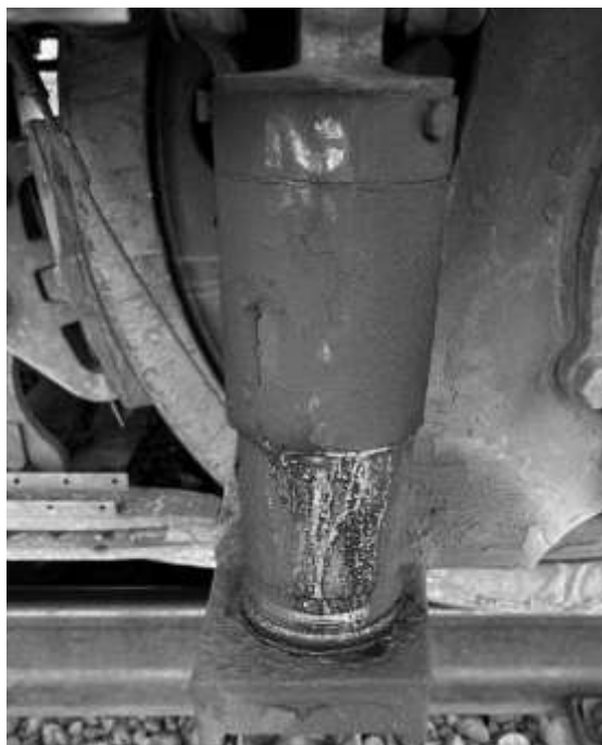
Рис. 2. Течь рабочей жидкости гидравлического гасителя колебаний буксового подвешивания электровоза ЗЭС5К «Ермак»
