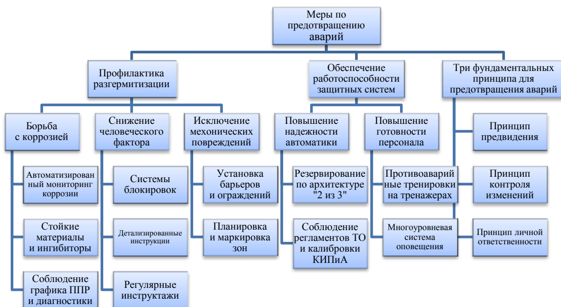
Рис. 2. Комплекс мер по предотвращению аварий
