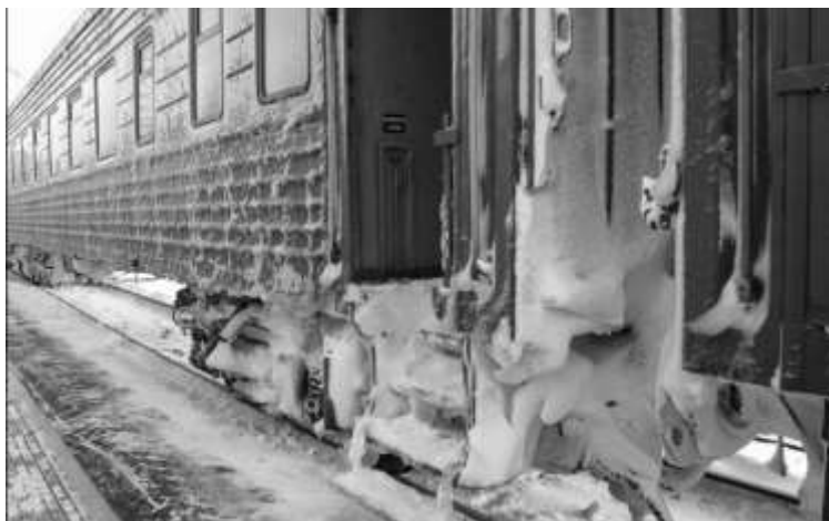
Рис. 1. Образование гололёдных явлений на элементах кузова и подвагонном оборудовании подвижного состава
