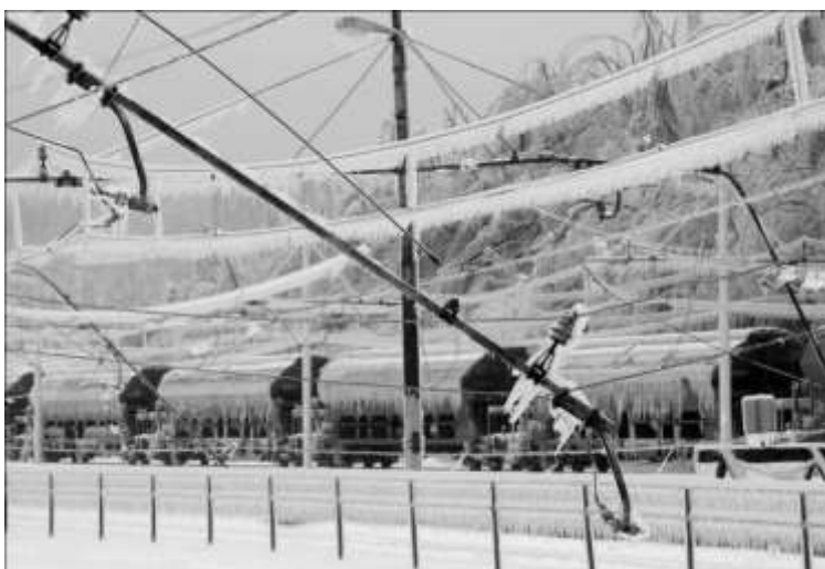
Рис. 1. Образование гололёдных явлений на элементах кузова и подвагонном оборудовании подвижного состава
