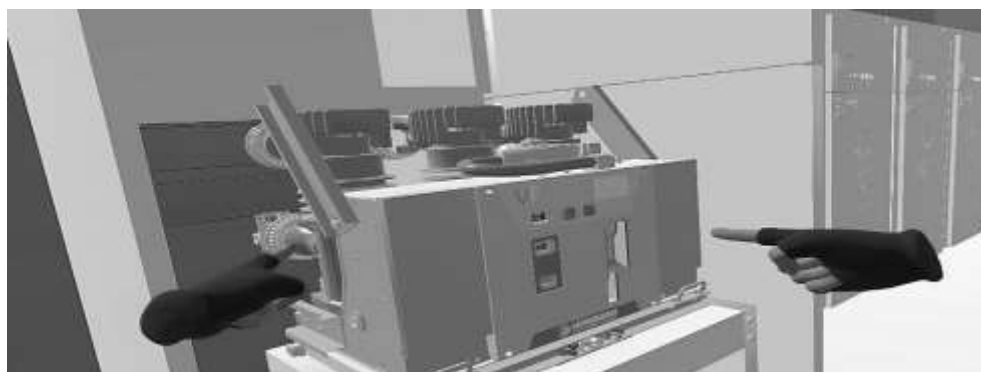
Рис. 2. Вакуумный выключатель ВВ-СВЭЛ-10 кВ в VR
