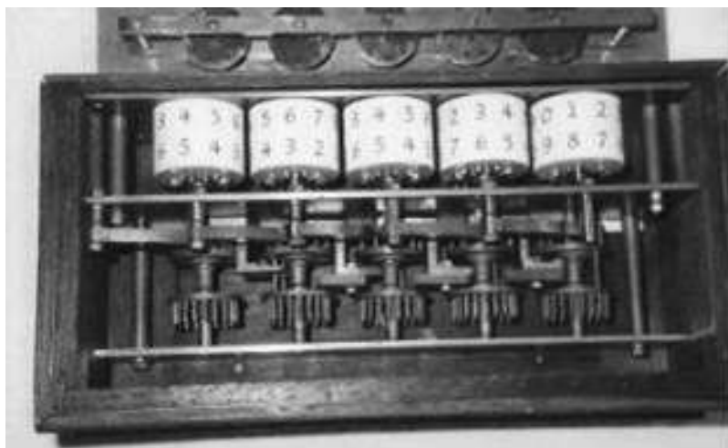
Рис. 8. Внутреннее устройство «Паскалины»
